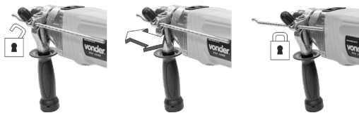
Fig. 11 – Utilizando el limitador de velocidad
